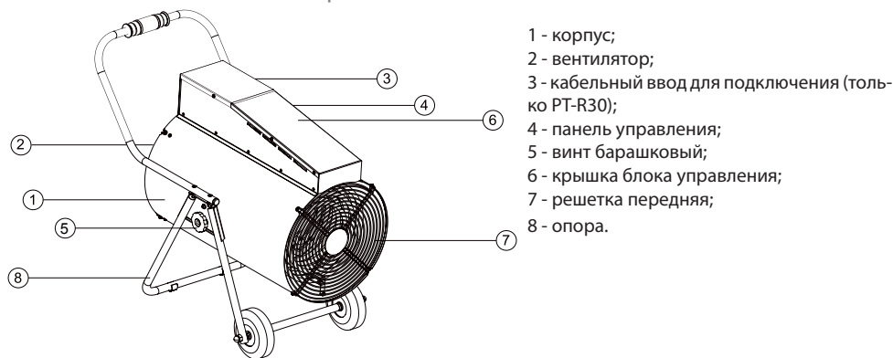
Рис. 1.1 Устройство прибора. Модели PT-R24, PT-R30
